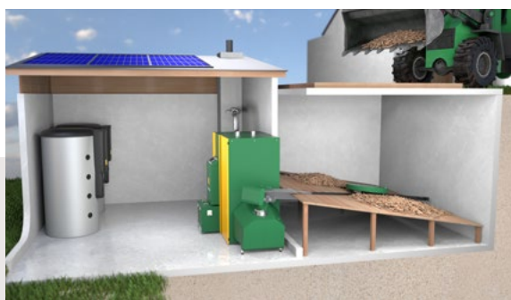
Chaudière en chaufferie séparée
