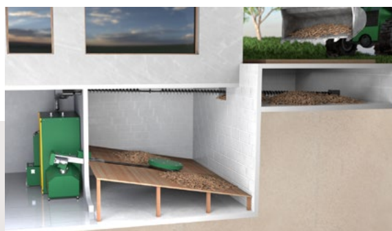
Chaudière au sous-sol avec vis de remplissage
