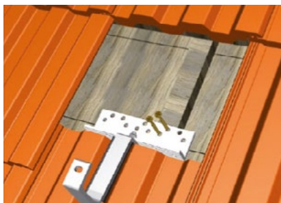
Montaggio staffe per tetto (DB 0°)
