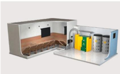
8-Punkt-Entnahmesonden mit Saugförderung
